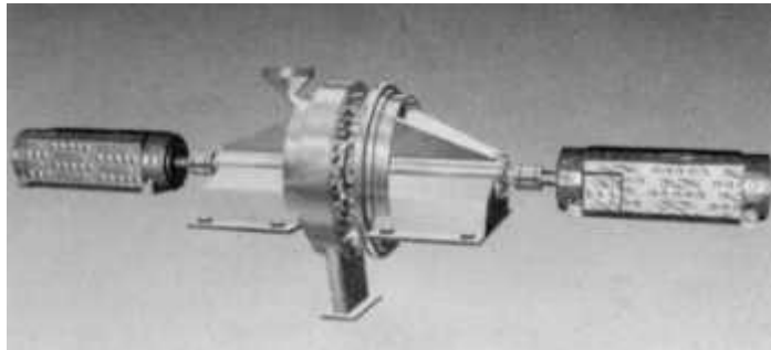
Die von Tihomir Lelas entwickelte Zerkleinerungsmaschine zur Herstellung des Megamins
